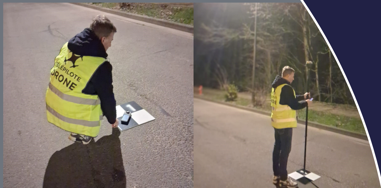
Relevés des niveaux d'éclairage et spectre lumineux avec une géolocalisation
